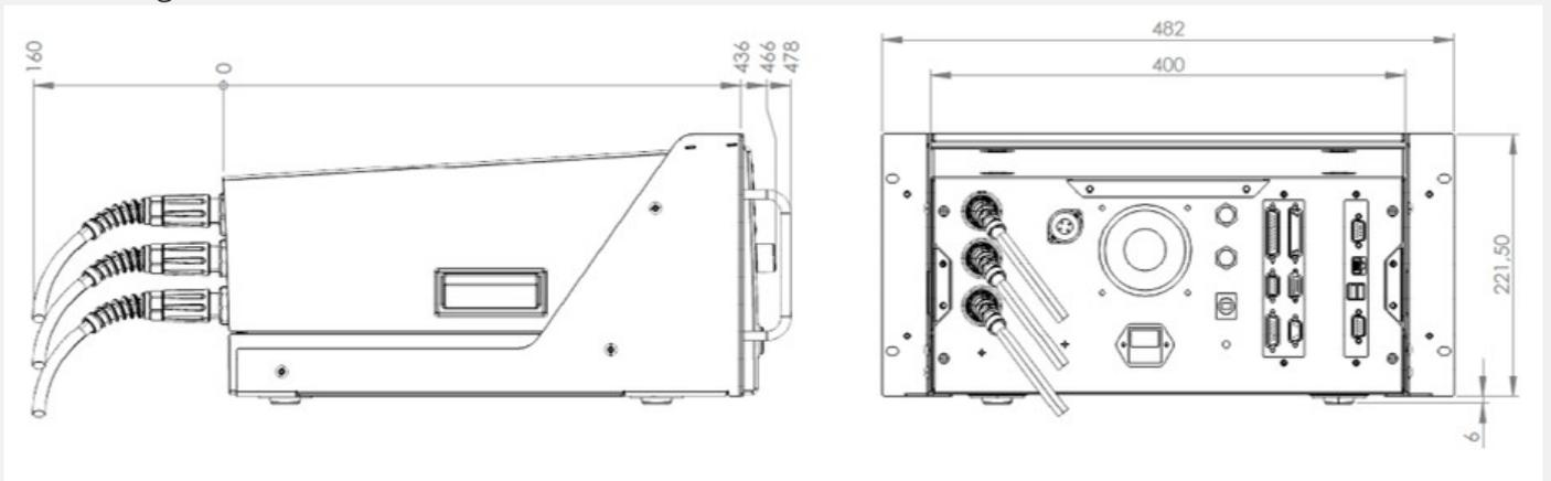
Abmessungen Gehäuse mit Einbausatz 19 Zoll und Winkelsteckern:
