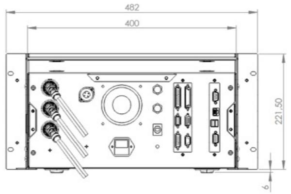
Abmessungen Gehäuse mit Einbausatz 19 Zoll und Winkelsteckern:
